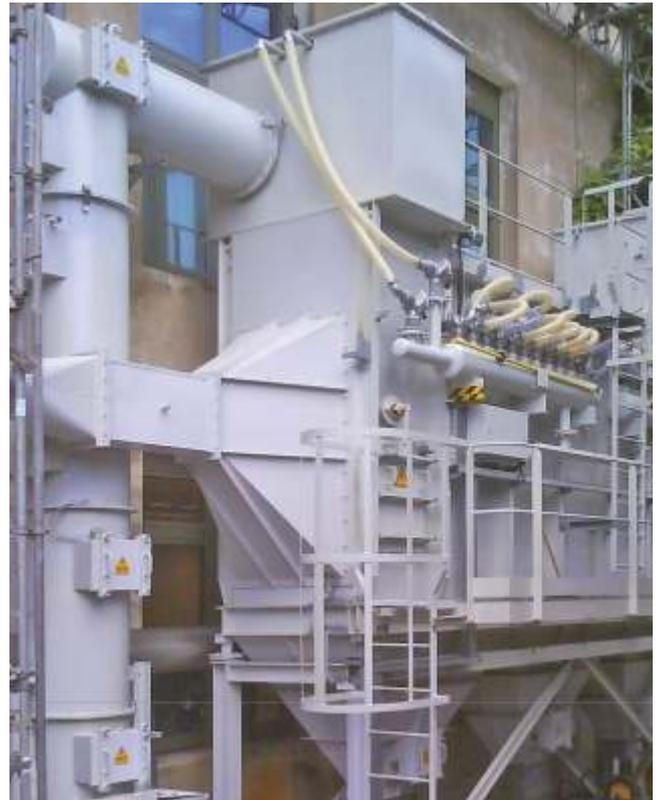
**Elektrofluidfilter** – Im Rahmen eines Forschungsvorhabens haben wir an der Universität RWTH-Aachen eine neuartige Elektrofilter-Innovation realisiert, die besonders für die Abscheidung von Feinststäuben und hohen Abgastemperaturen bis 600 °C geeignet ist.
