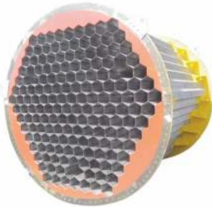
Die Röhren mit dem sechseckigen Querschnitt (Wabenform).
